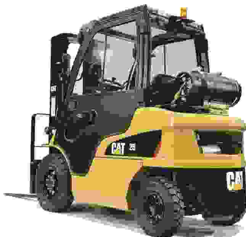
Cabina panelada con puertas de acero
